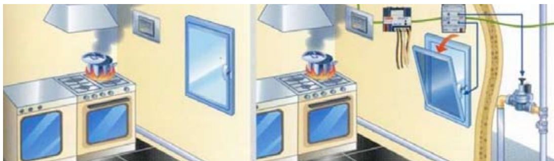
Controllo fumi, apertura finestra e chiusura impianto gas. Rauchkontrolle, Fensteröffnung und Schließung der Gasanlage.
